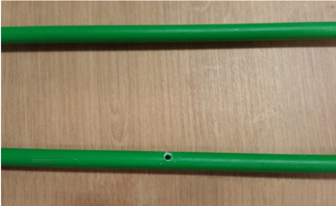
Beschädigte Stelle mit einer Rohrschere herausschneiden
