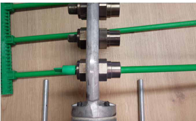
Mittels Reparaturdorn-Set und Außen-Stopfen beide Enden verschweißen
